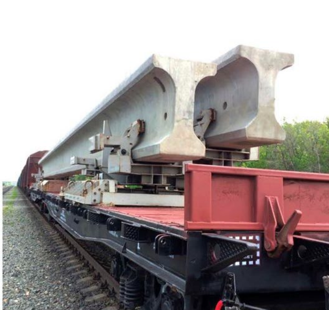
Груз : часть мостового крана. Маршрут Магнитогорск-Сибай. Длина 29 метров. Вес 16 тн
