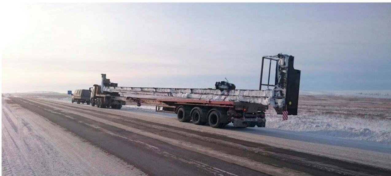
Груз : часть мостового крана. Маршрут Магнитогорск-Сибай. Длина 29 метров. Вес 16 тн
